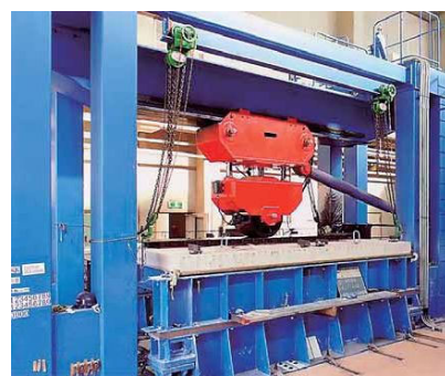
旧建設省土木研究所における輪荷重走行試験
